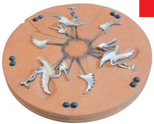
Nicem produce mescole siliconiche specifiche per la colata di leghe di stagno e zinco e per la colata di resina poliestere, poliuretanica ed epossidica.
